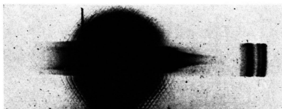
Abb. 3. Sekundärschwärzungsfigur beim Jenaer Massenspektrographen. Q2-Platte S 4374. 11 keV-K + -Ionen. Exposition 3 \cdot 10^{-8} Coulomb. Ionenstrom 1,5 \cdot 10^{-9} A. Aufladungspotential 3,2 \cdot 10^{-4} kV.
